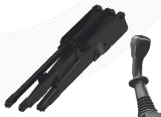
Дополнительно оснащается джойстиком и удлинителем стрелы
