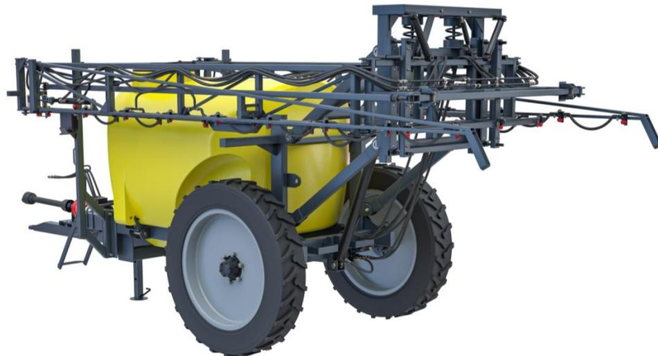
По заказу потребителя ОПШ может быть дооснащен опциональным оборудованием, расширяющим его производственные возможности: установка заправочной магистрали для забора воды с фильтром повышает удобство и автономность работы агрегата, позволяет использовать собственный насос опрыскивателя для само закачки воды из внешних источников и водоёмов.
