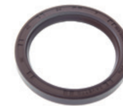
Артикул 103-3502020 Наименование Сальник МАЗ-6430, 5440 опоры кулака разжимного 1.2-42x54x7 Viton
