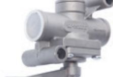
Артикул 350-17-001 Наименование Кран КАМАЗ,МАЗ,КРАЗ,УРАЛ разобщительный Cross № • 163520010 • 35200040010 • 100-3520010 • 123520010-10 Применяемость для а/м КАМАЗ, МАЗ, КРАЗ, УРАЛ
