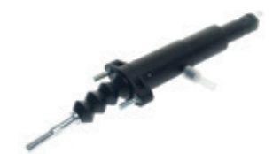
Артикул 160-16-031 Наименование Цилиндр сцепления главный ГАЗон Next дв.CUMMINS ISF 3.8, ЯМЗ-534 в сборе
