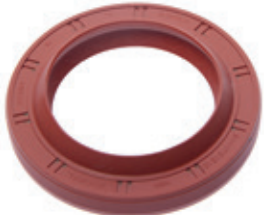
Артикул 51-1701210 Наименование Сальник ГАЗ-53,ПАЗ КПП вала вторичного 2.2-51х76х9.5/.14.5 Cross № • 51-1701210
