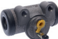
Артикул 350-35-018 Наименование Цилиндр тормозной задний, передний ПАЗ-3205
