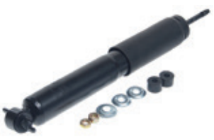
Артикул 290-12-002 Наименование Амортизатор ГАЗ-2217, 2752 передний масляный
