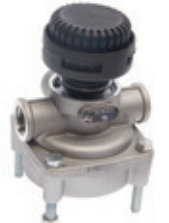
Артикул 350-19-004 Наименование Клапан ЗИЛ,КАМАЗ,МАЗ,УРАЛ ускорительный в сборе с шумоглушителем Cross № • 8001351801020 • 2233-3518010-20 Применяемость для а/м ЗИЛ, КАМАЗ, МАЗ, УРАЛ
