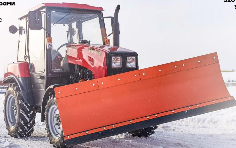
\* Для тракторов Беларус 320, 1221, 1523 доступна модификация "накладной отвал", позволяющая устанавливать подрамники отвала совместно с подрамниками погрузчика.
