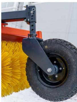
**Стойки колеса усилены:** изготавливаются из квадратной трубы 50x50x4 мм.
