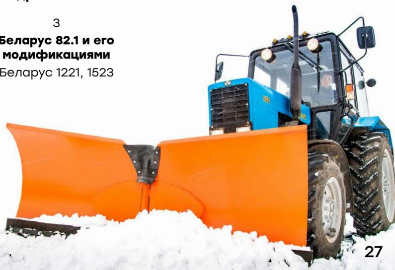
**Отвалы к трактору с универсальной лопатой** (далее - универсальные отвалы) имеют две рабочие поверхности: одна с резиновыми ножами, другая с металлическими съёмными ножами. Морозостойкие резиновые ножи армированы тросом. При необходимости, лопату можно перевернуть.
