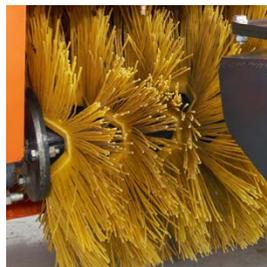
**+ 15% производительность щёточных дисков типа бил-лайн.** Диски зигзагообразной формы охватывают 100% поверхности. Изготовлены из первичного полипропилена для максимальной износостойкости.
