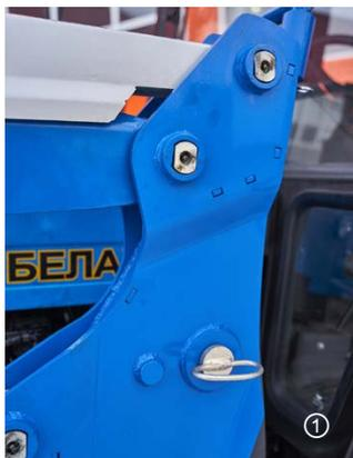
Чтобы максимально облегчить монтаж и демонтаж погрузчика на трактор и установку рабочих органов на погрузчик, **погрузчики Универсал могут быть оснащены быстросъёмами с трактора и быстросъёмами рабочих органов.**
