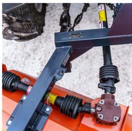
**Приводной механизм защищён от деформаций,** так как мы не используем корпус редуктора в качестве несущей рамы. Применяем редуктор с литым корпусом и промежуточный карданный вал.
