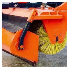
**Бункер для сбора мусора на 200 литров.** При навешивании щётки на погрузчик можно высыпать мусор в кузов грузового автомобиля или прицепа.
