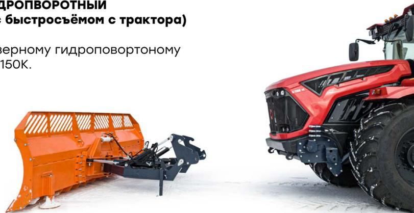
Система быстросъёма с трактора позволяет установить/снять отвал без грузоподъёмного устройства за 5 минут.
