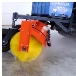
**Система полива (обеспыливания) работает под давлением.** Жидкость разбрызгивается веерно через форсунки, обеспечивая эффективное увлажнение и экономичность расхода.
