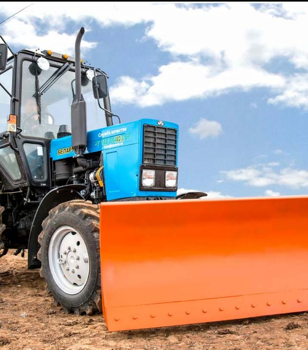
**ОТВАЛ БУЛЬДОЗЕРНЫЙ ГИДРОПОВОРОТНЫЙ
