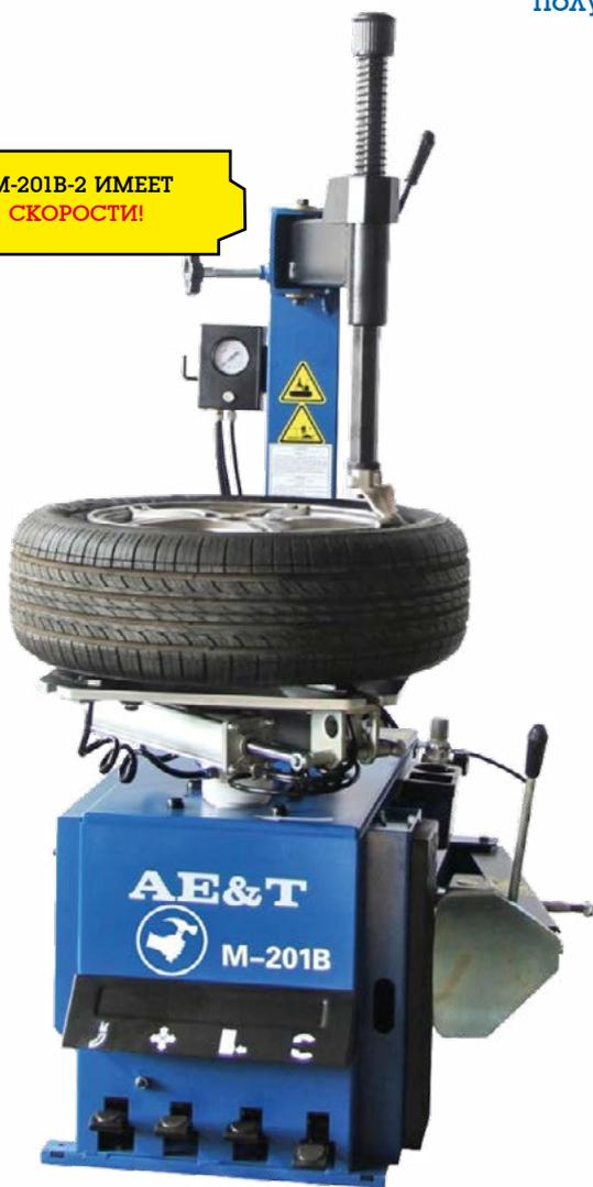
Шиномонтажный стан с наддувом для монтажа и демонтажа шин с посадочным диаметром от 10 до 24 дюймов. Монтажная стойка не откидывается, но это делает аппарат значительно компактнее и проще в обслуживании. Монтажный стол обладает долговечным механизмом вращения и двумя скоростями.
