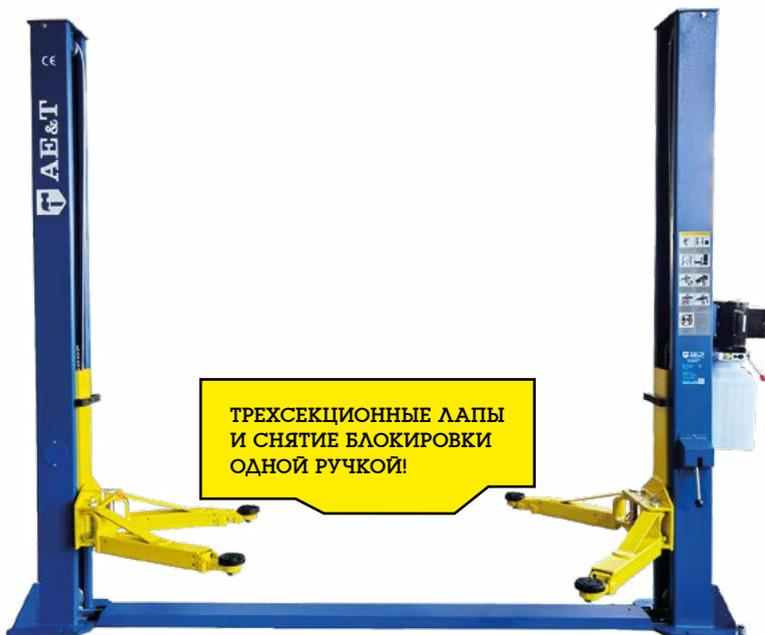
Подъемник 2-стоечный T4MU (модель 2022 года). Предназначается для подъема автомашин массой до 4 тонн на высоту до 1,8 м. Снятие с замков безопасности одной ручкой. Минимальная высота подхвата 90 мм. Плавный подъем-спуск техники за 45 сек. Подъемник можно использовать для ремонта и обслуживания транспортных средств на СТО любого уровня.
