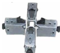
Салазки с зажимными лапками для шиномонтажного стола увеличенной высоты, 4 штуки. Установка салазок очень проста, может сделать даже ребенок. Комплект может быть установлен в два положения. В первом положении лапки встанут в так же, как и на станке, во втором – на два дюйма ближе к центру стола.
