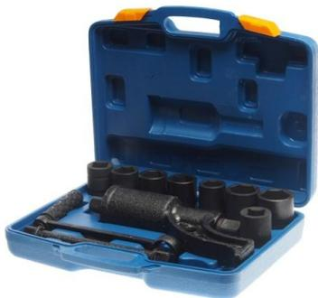
**Механический гайковерт (также известный как «Мясорубка», «Баллонный ключ с редуктором» или «УКМ») — это достаточно простой, очень надежный и часто незаменимый инструмент для работы с резьбовыми соединениями. Он в десятки раз облегчает затягивание и ослабление гаек и болтов за счет мультипликатора, являющегося основным элементом данного инструмента.**
