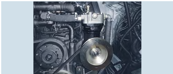
Вариант установки компрессора на автобусы ПАЗ-4234 и ПАЗ-4230 с дизельным двигателем ММЗ D245.9
