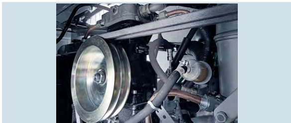
Вариант установки компрессора на автобус ПАЗ-32053 с бензиновым двигателем ЗМЗ-5234
