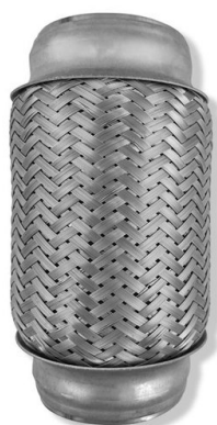
Гофра глушителя 3-слойная InnerBraid Компенсатор несущий, наружная оплётка сетчатая OuterBraid, 2-слойный сильфон, внутренний экран сетчатый InnerBraid Материал: нержавеющая сталь марки AISI 201
